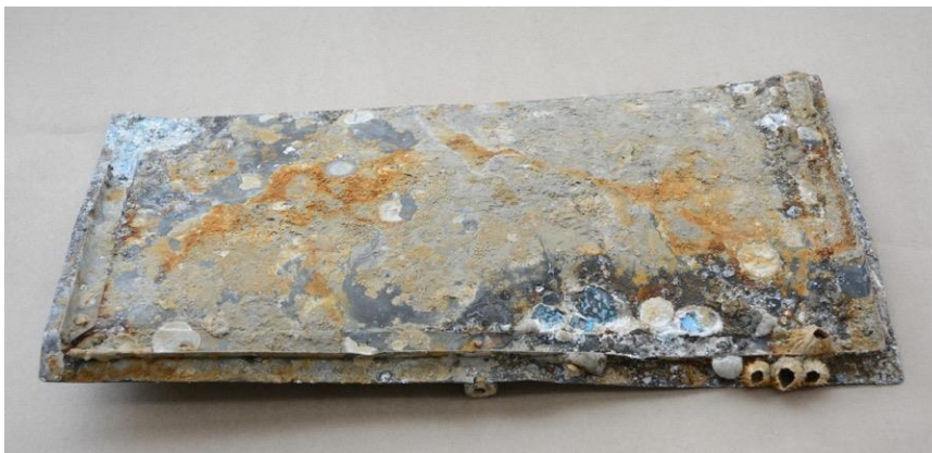
Figure 15 : Porte de boîtier d'équipement provenant du Catalina (épave américaine de 1942, localisée dans le fleuve Saint-Laurent à hauteur de la ville de Mingan). La couleur orangée est due à la corrosion d'artéfacts en fer provenant de la même épave. La matière beige est composée essentiellement de sédiments marins. Sous ses sédiments, on a trouvé la peinture kaki intacte et l'aluminium en bon état, sauf aux endroits des creux turquoise. © Kateri Morin, CCQ
