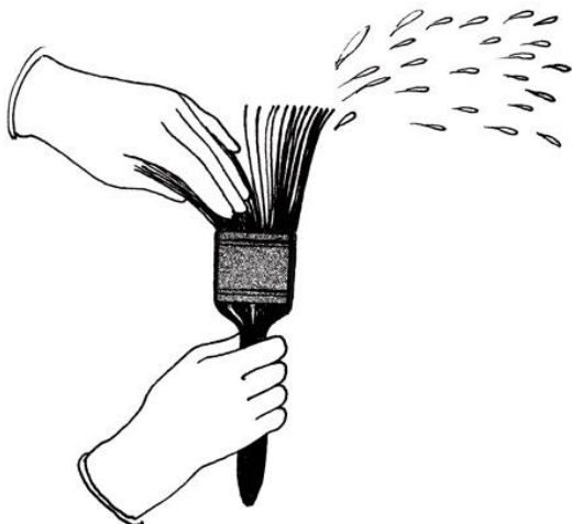
Figure 38 : Projection de latex sur une paroi. © CCQ
