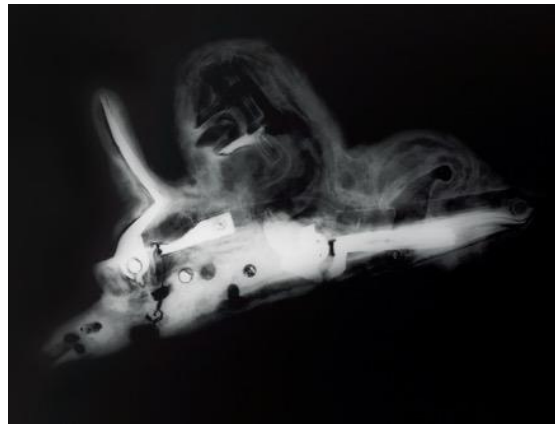
Figure 14-B : Radiographie de cette concrétion révélant la présence d'une platine de fusil. © Michel Élie, CCQ
