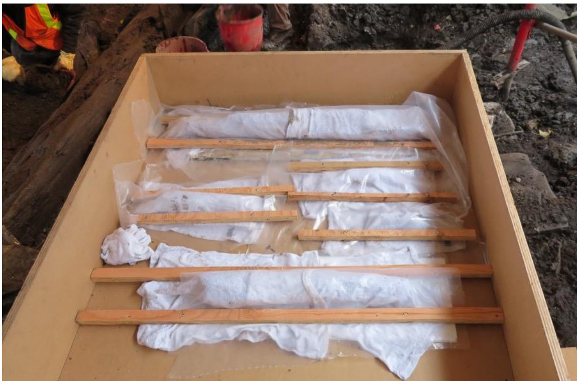
Figure 5 : Exemple de caisse de transport d'objets gorgés d'eau vers un atelier de restauration. Au moment de leur prélèvement, les pièces de bois fragiles ont été déposées sur un plastique rigide, qui a été vissé dans le fond de la caisse. Elles ont ensuite été recouvertes d'un textile qui a été imbibé d'eau; une feuille de polyéthylène recouvre chaque pièce. De petites pièces de bois ont ensuite été placées entre chaque objet et vissées dans le fond de la caisse. Un couvercle a protégé les pièces lors de leur transport. Chaque caisse a été rapidement placée en réfrigération (température de 5 °C), ce qui a permis de gagner du temps, alors que les découvertes ont été nombreuses. © André Bergeron, CCQ
