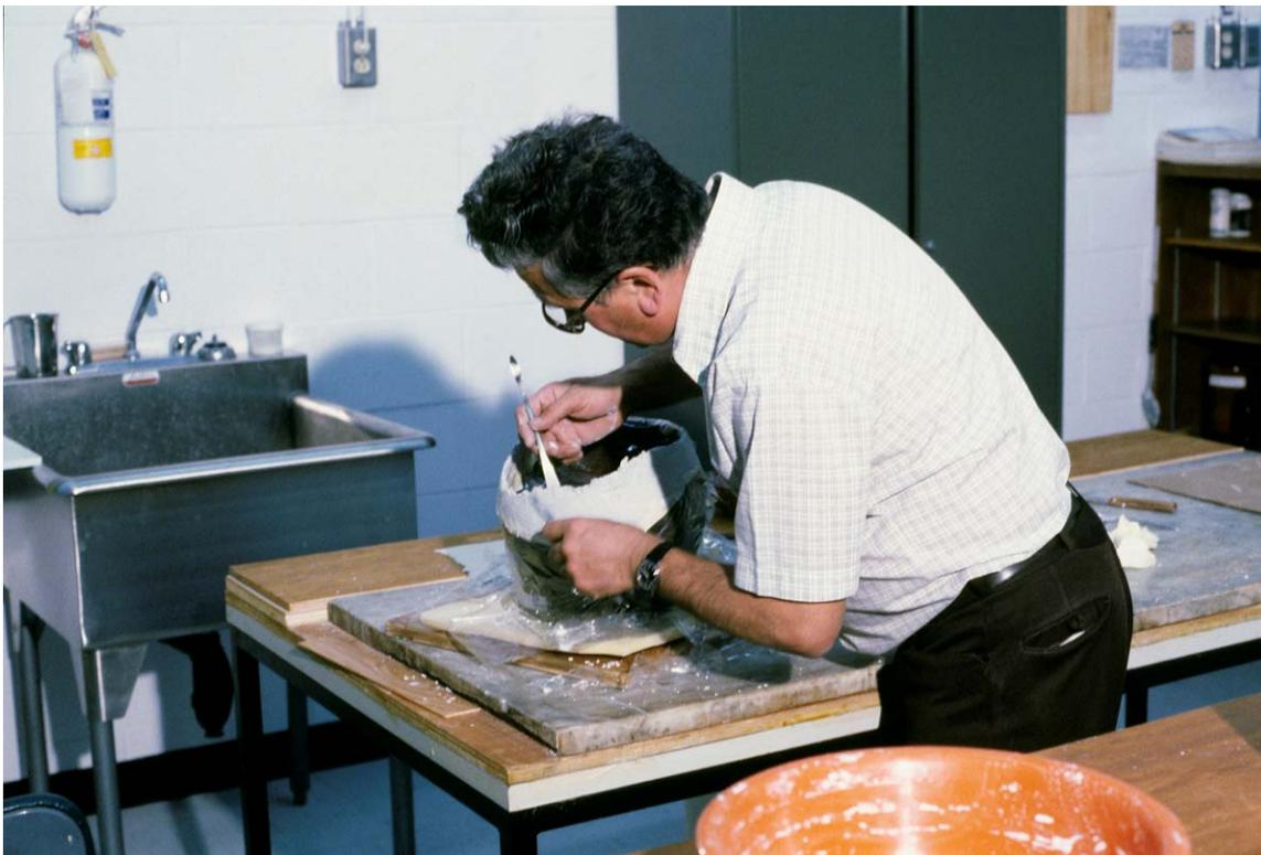
**Figure 23 :** Vue de la poterie du lac Kipawa pendant sa restauration. Gaston Montreuil effectue ici le comblement sur l'objet.
