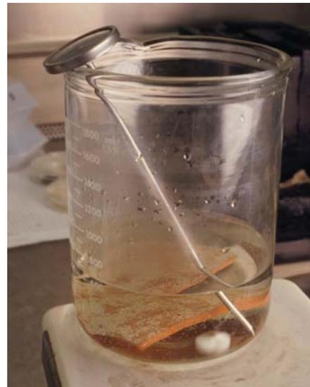
**Figure 96 :** Le traitement chimique d'un tesson provenant du *Elizabeth and Mary*. Un agitateur assure une bonne dispersion du complexant et un thermomètre permet la vérification de la température de traitement.
