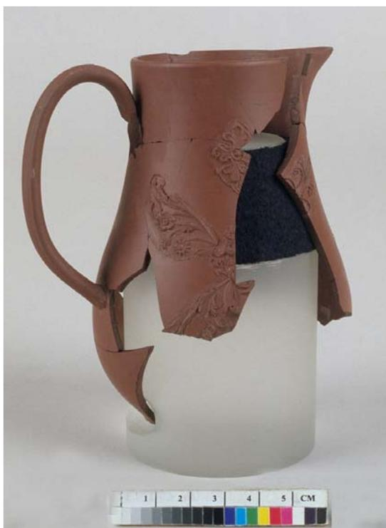
**Figure 83 :** Support fabriqué à l'aide d'une tige de plexiglas massif<sup>77</sup>.
